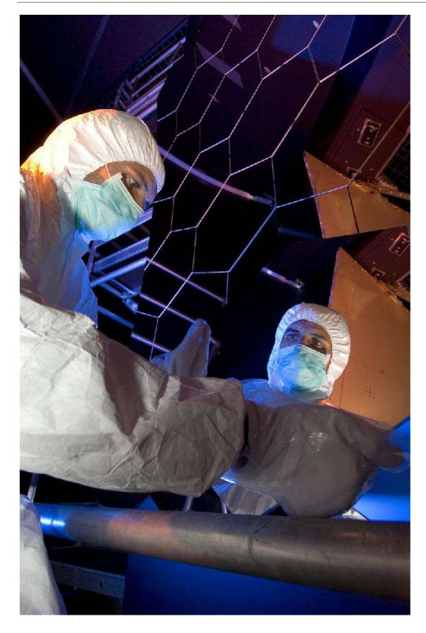
La luce Cherenkov emessa in un gas si riflette sugli specchi e viene convertita in segnale elettrico da fotomoltiplicatori (PMT)
