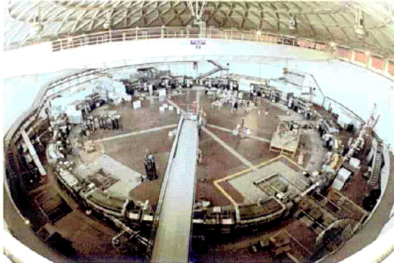
La **costruzione della nuova macchina iniziò nel 1963** e il primo elettrone fu immagazzinato nel 1967. Un LINAC di 350 MeV fu utilizzato come iniettore. La corrente massima circolante in ADONE era di **100 mA in 3 pacchetti**.
