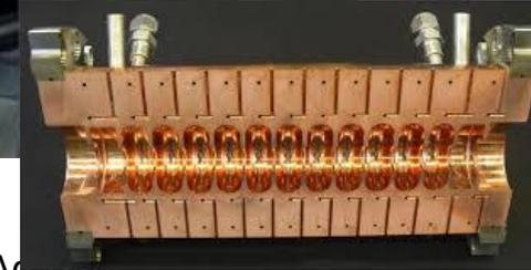
Con l'utilizzo di **dipoli** il fascio può anche essere fatto circolare all'interno di un **anello** in cui si ha un'unica cavità acceleratrice. Ad ogni passaggio il fascio di particelle acquista energia. Queste macchine sono dette **sincrotroni**.
