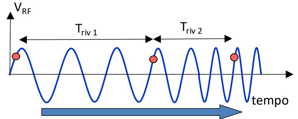
Durante l'accelerazione la **frequenza RF aumenta** per mantenere il sincronismo tra particella e campo accelerante: **sistema RF complesso**
