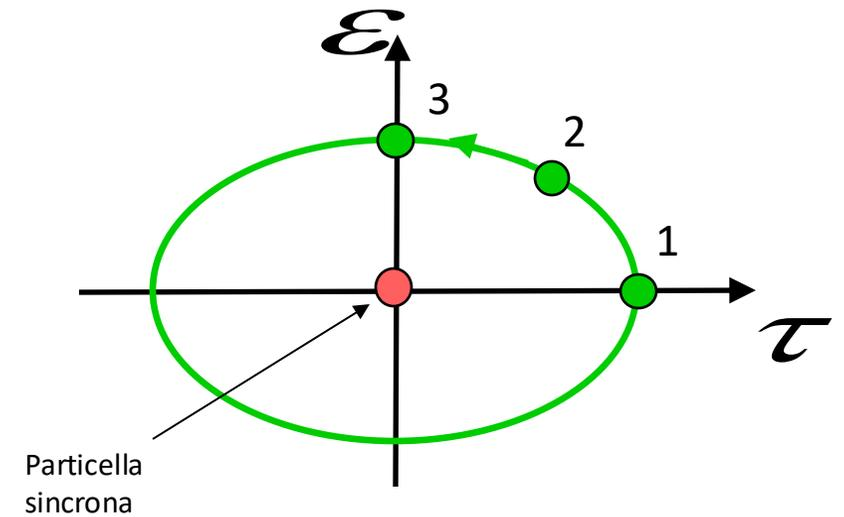
Nel piano  $(\tau, E)$  detto spazio delle fasi longitudinale una particella non sincrona descrive una ellisse che percorre con una frequenza pari proprio alla frequenza di sincrotrone.
