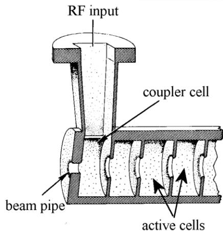
Esistono sia cavità che operano a **temperatura ambiente** (tipicamente in rame) che **cavità superconduttive** che operano a qualche K. I **gradienti acceleranti medi** che si possono tipicamente ottenere sono dell'ordine di **qualche 10 MV/m**. Tali gradienti possono arrivare anche a **>100 MV/m**.
