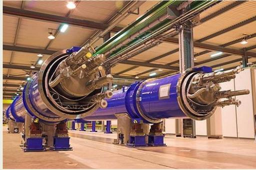
I massimi campi magnetici ottenibili con dipoli **superconduttori** sono dell'ordine di 15-20 T (8 T LHC)
