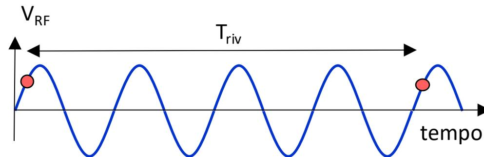
Per avere accelerazione “stabile” ovvero per fare in modo che la particella dopo un giro veda sempre la stessa tensione accelerante in cavità, il periodo di rivoluzione ( $T_{riv}$ ) deve essere un multiplo intero ( $h$ ) del periodo di radiofrequenza ( $T_{RF}$ ) ad ogni giro.
