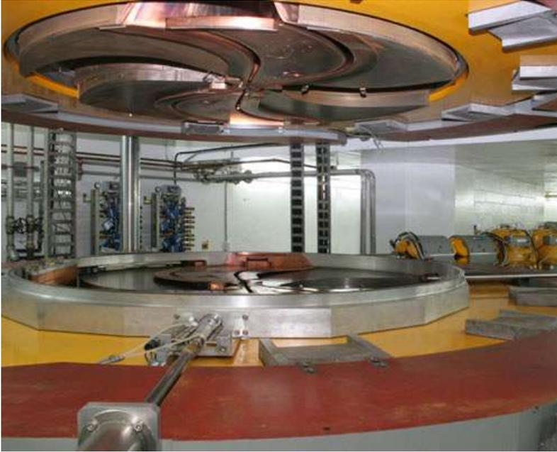
Il *ciclotrone* è stato progettato con l'intenzione di superare le limitazioni dell'*acceleratore lineare*. All'epoca (1930) non era possibile generare onde radio contemporaneamente ad alta frequenza ed alta potenza, per cui gli stadi di accelerazione lineare (DTL) dovevano essere spazati tra loro ed erano necessari più stadi (per compensare la limitata potenza). **Per ottenere energie elevate era necessario costruire acceleratori lunghi** e, oltre un certo limite, troppo costosi.
